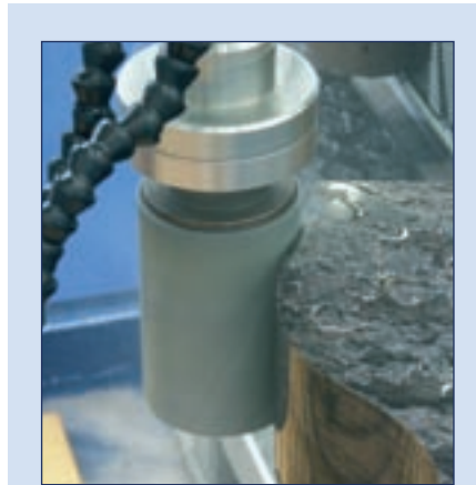
6 Bei Schleif- und Polierwalzen setzen die Werkzeugbauer auf ein niedriges Gewicht und hohen Gleichlauf
