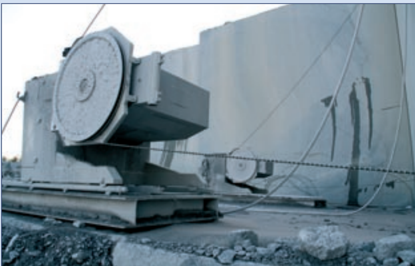
7 Diamantseilsägen setzen sich auch im Hartgestein beim Blockabbau durch
