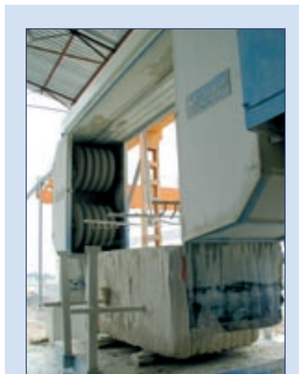
2 Multiseilsäge von Bideseimpianti im Einsatz in Spanien
