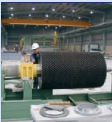
8 Optimierungen an Bindung und Segmentform bringen mehr Ausstoß in der Fliesenproduktion: Montage von Trennscheiben für eine Taglia Blocchi-Säge
