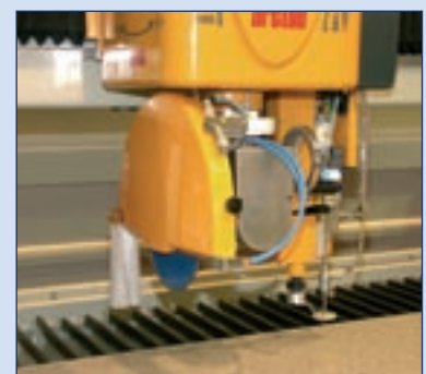
5 Breton kombiniert bei seiner Combicut eine Brückensäge mit einem Wasserstrahlaggregat. Die Software entscheidet, welche Schnitte mit der Trennscheibe und welche mit „waterjet“ durchzuführen sind
